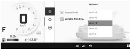
**NOTA:** Al cambiar la posición de ajuste del sistema VTS sin que el motor esté en posición de avance, solo cambia la indicación. La tobera se desplazará a la posición de ajuste del sistema VTS seleccionada cuando se acciona el modo de impulso de avance.
