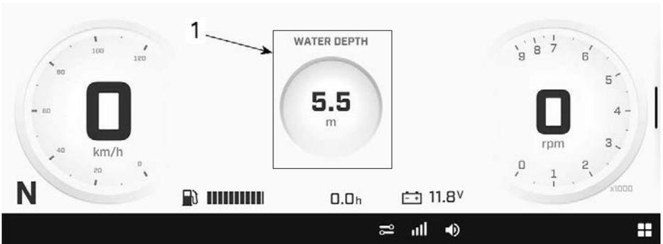
1. L'indicateur de profondeur affiché dans cette section peut être retiré par une longue pression.
