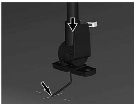
3. Insérez deux boulons M4 dans les trous du feu de navigation et de la housse Bimini.
