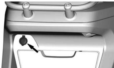
Avant et pendant l'utilisation, assurez-vous que le joint autour du port de charge USB 12 volts est intact et correctement positionné.
