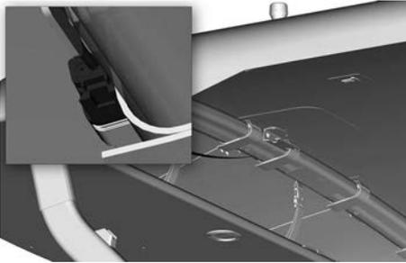
2. Retirez les deux boulons M4 et les contre-écrous qui fixent ce feu à son support de montage. Jetez les contre-écrous.
