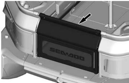
2. Soulevez la porte et faites-la pivoter pour l'ouvrir à l'intérieur de l'embarcation. Assurez-vous qu'aucun objet ou débris ne puisse bloquer la porte.
