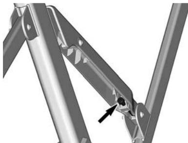
**BOULON DE TENSION BIMINI - CÔTÉ GAUCHE**
