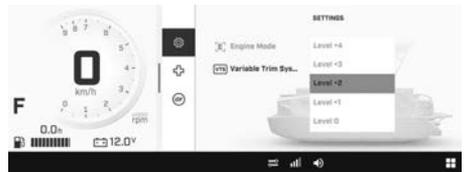
**REMARQUE :** Si vous modifiez la position d'assiette VTS sans que le moteur exerce une poussée vers l'avant, le réglage ne change pas, mais l'indication est modifiée. Dès que le moteur exerce une poussée vers l'avant, la sortie de la turbine se déplace conformément au réglage de la position d'assiette VTS sélectionnée.
