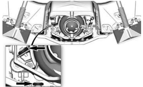
Vérifier si l'anode est usée. Si l'usure dépasse la moitié de l'anode, la faire remplacer par un concessionnaire autorisé d'embarcations Sea-Doo.
