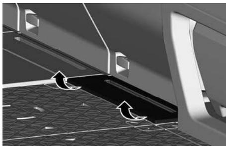
Pour l'installer, il suffit de pousser sur chaque coin à l'aide des ancrages d'angle. Assurez-vous que la surface est complètement plate et fixée.
