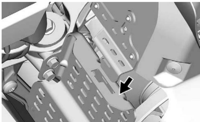
2. Poussez le protège-courroie de distribution vers l'avant du moteur pour vers l'avant du véhicule.
