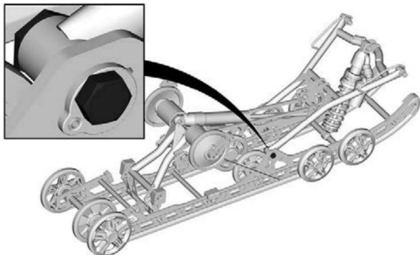
6. Retirez la came, pivotez à 180°, réinstallez dans le rail.
