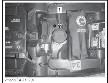
1. Behälter für Bremsflüssigkeit der hinteren Bremse
