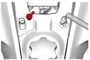
TYPICAL — DRIVER - ELECTRIC VISOR JACK CONNECTOR LOCATION
