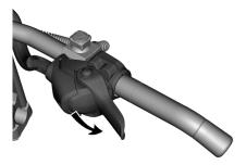
THUMB THROTTLE POSITION : PUSH DOWNWARD TO ROTATE THROTTLE HOUSING
