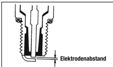
Achten Sie beim Einbau der Zündkerze darauf, diese fest anzuziehen. Eine neue Zündkerze sollte um eine halbe Umdrehung angezogen werden, sobald die Unterlegscheibe den Zylinderkopf berührt. Eine gebrauchte Zündkerze sollte um 1/8 bis 1/4 Umdrehung angezogen werden, sobald die Unterlegscheibe den Zylinderkopf berührt.
