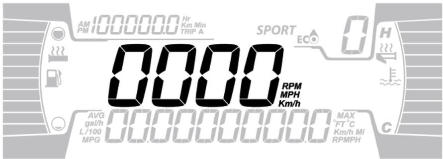
Zeigt die Drehzahl des Motors oder die Fahrzeuggeschwindigkeit in Km/h oder MPH an.
