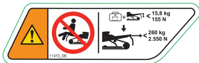
MAXIMALE ZULADUNG UND ZUGLAST - WARNSCHILD
