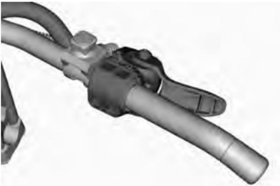
**GASHEBELPOSITION FÜR FINGERBETÄTIGUNG**
