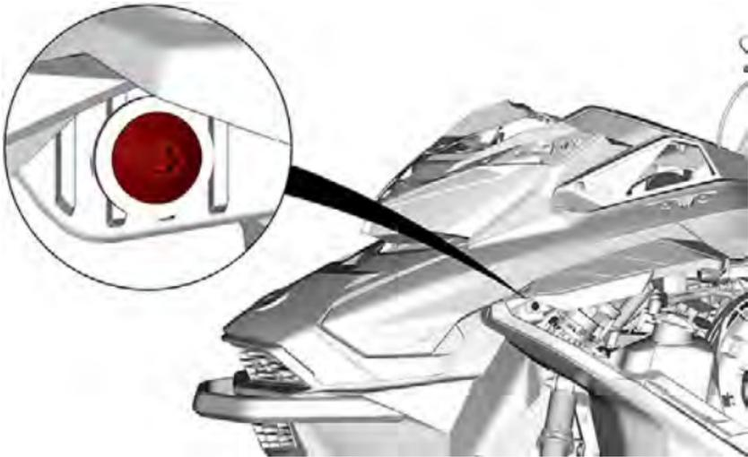
11. Heben Sie das hintere Ende der seitlichen Haube an, bis sich die Laschen aus der hinteren Konsole lösen.
