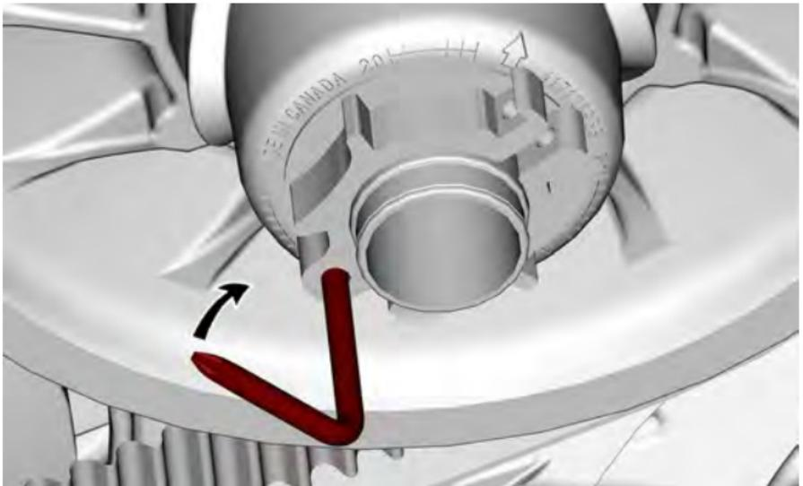
5. Öffnen Sie die Abtriebsscheibe, indem Sie das Werkzeug hineindrehen.
