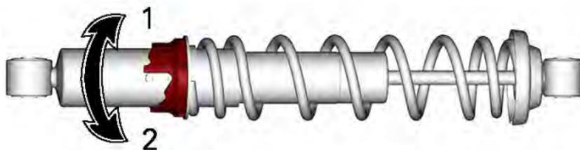
1. Vorspannung erhöhen
