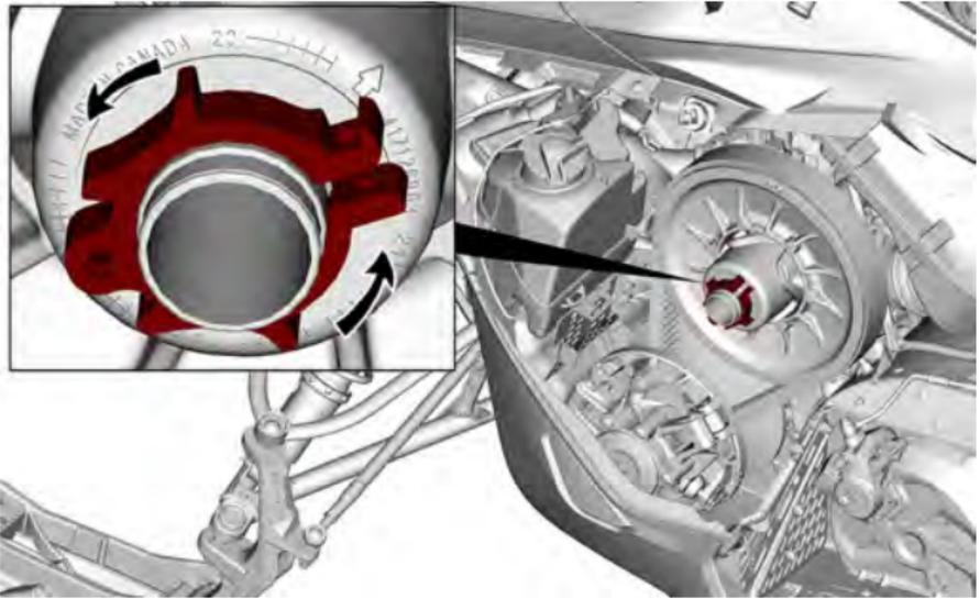
4. Drehen Sie den Abtriebsscheiben-Expander wie abgebildet in die Gewindebohrung an der Nabe der Einstellvorrichtung ein.
