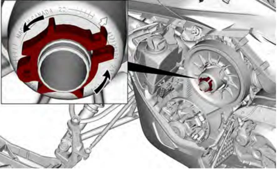
4. Vissez l'écarteur de poulie entraînée dans le trou fileté du moyeu de réglage comme indiqué.
