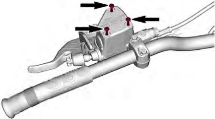
3. Retirez le bouchon de réservoir.
