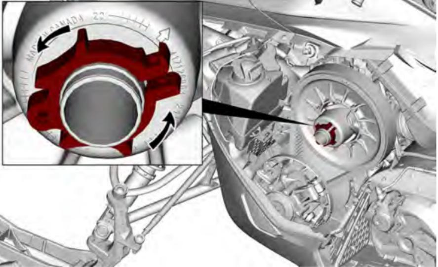
4. Avvitare il dispositivo di espansione della puleggia condotta nel foro filettato sul mozzo del registro, come illustrato.
