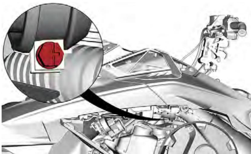
10. Rimuovere le viti di fissaggio del modulo superiore della scocca su entrambi i lati.
