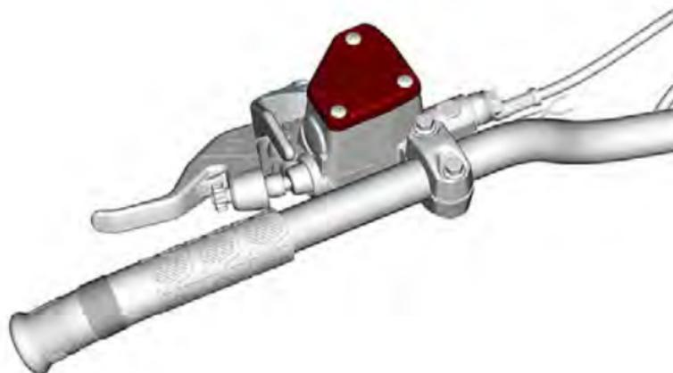
2. Rimuovere le viti di bloccaggio del tappo del serbatoio.
