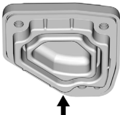
6. Reinstallare il tappo del serbatoio e le viti. Serrare come da specifiche.
