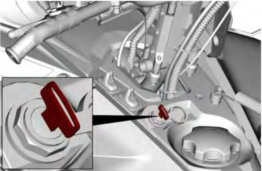
Girare la chiave di accensione per avviare il motore. Vedere *Procedura di avvio del motore* nella sottosezione *procedure di base*.
