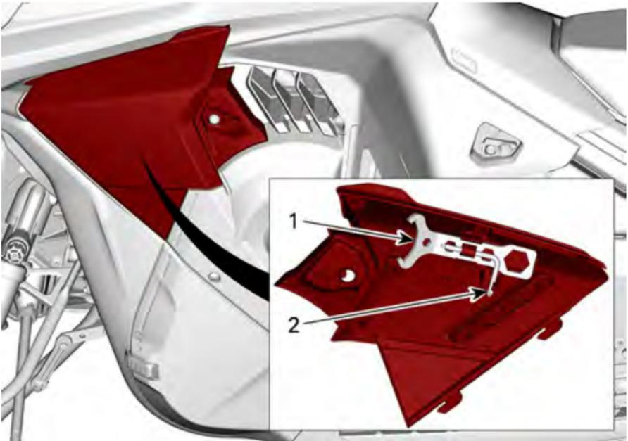
1. Strumento di regolazione delle sospensioni
