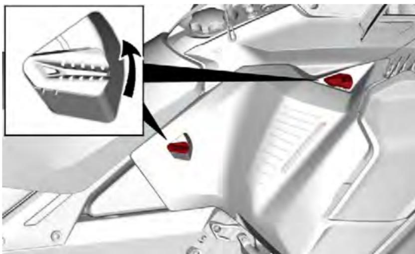
**CONFIGURAZIONE TIPICA — 2 SERRATURE**
