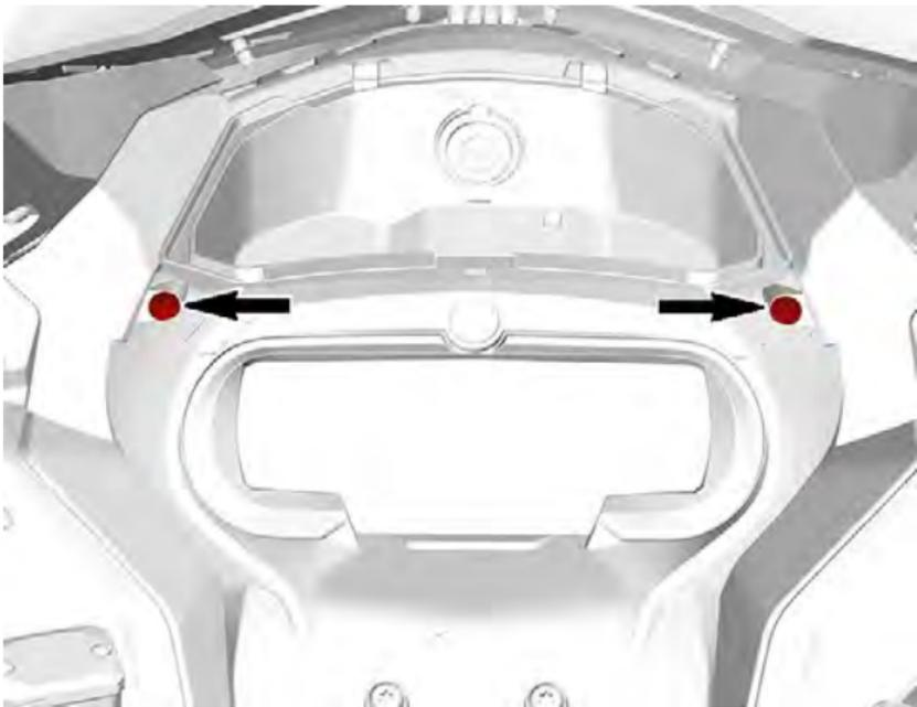
4. Sollevare la parte anteriore del supporto dell'indicatore, quindi farlo scivolare in avanti per rimuoverlo.
