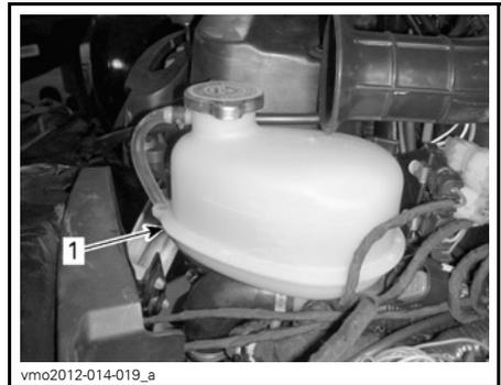
1. Depósito de refrigerante del motor
