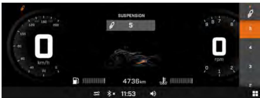
6. Utilisez l'écran tactile ou le bouton haut/bas du commutateur multifonction pour modifier le niveau de suspension.
