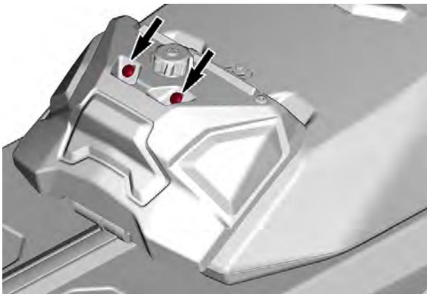
2. Inclinez le réservoir de fluide ICE vers l'arrière pour accéder à la batterie.
