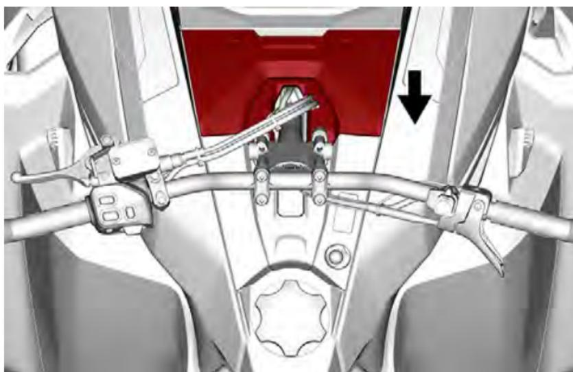
2. Vérifiez le niveau de liquide de refroidissement à la température ambiante. Le liquide doit toucher la surface plate de la lunette.
