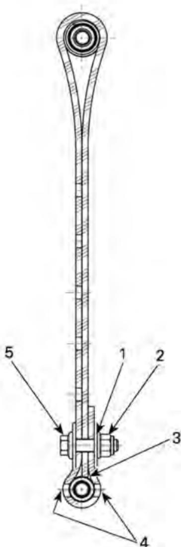
**POSITION 1 DE COURROIE D'ARRÊT (1ER TROU, LE PLUS LONG) – RÉGLAGE D'USINE**
