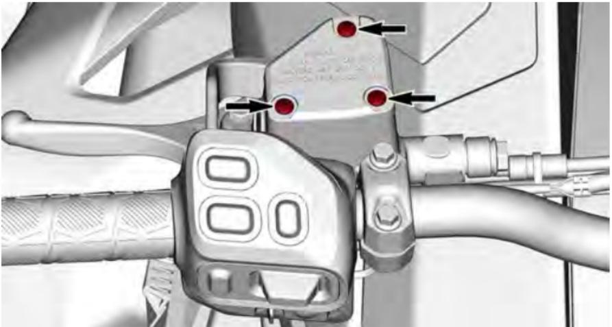
3. Retirez le bouchon de réservoir.
