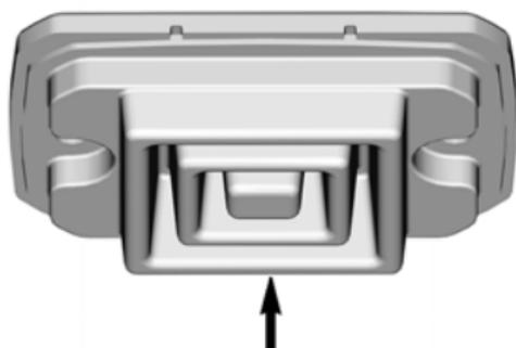
6. Réinstallez le bouchon de réservoir et les vis. Serrez au couple recommandé.
