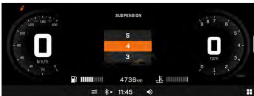
**Modifiez le niveau de suspension avec le bouton Paramètres Conduite**
