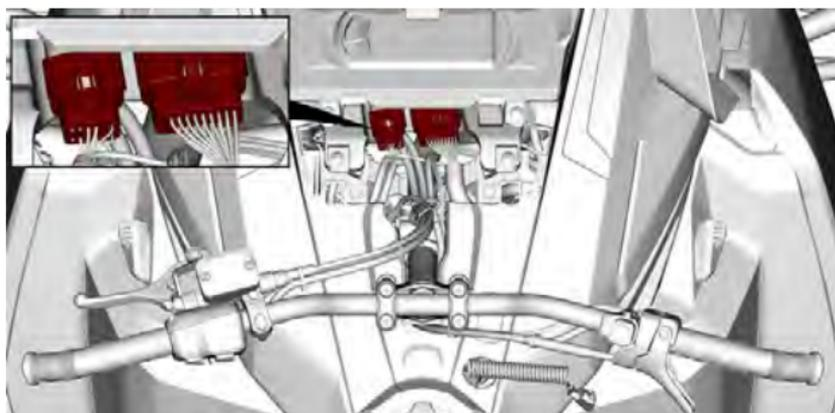
4. Retirez les vis de fixation du module de carrosserie supérieur des deux côtés.
