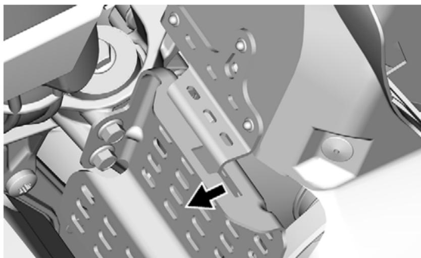
3. Placez la partie arrière du protège-courroie sur le dispositif de retenue et fixez-le à l'aide de la goupille.
