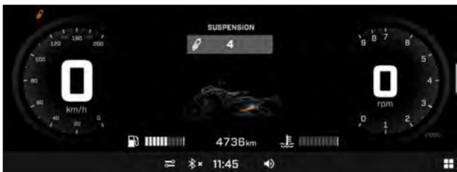
4. Utilisez l'écran tactile ou le bouton haut/bas du commutateur multifonction pour modifier le niveau de suspension.
