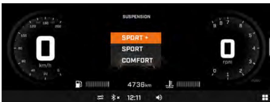
***Modification du mode Smart-Shox avec le bouton Paramètres Conduite***
