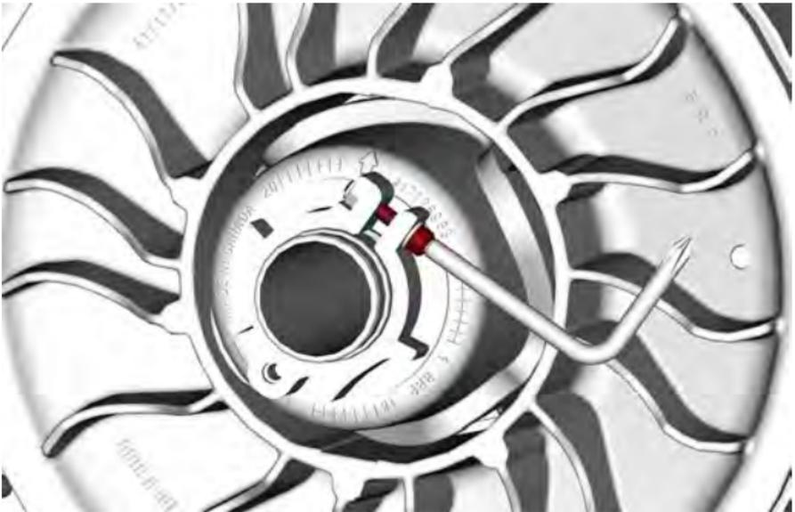
2. Avec l'outil de réglage de la suspension fourni dans la trousse à outils, tournez la bague de réglage d'un seul quart de tour à la fois. Tournez la poulie entraînée pour positionner précisément la courroie entre les flasques de la poulie.
