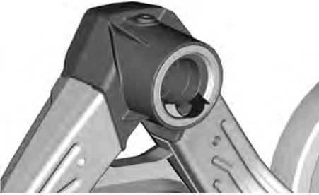
2. Lubrifiez la bague d'usure du moyeu. Appliquez 2 ml (0,07 fl oz (US)) de graisse sur toute la largeur et la circonférence (360°) de la bague d'usure du moyeu.
