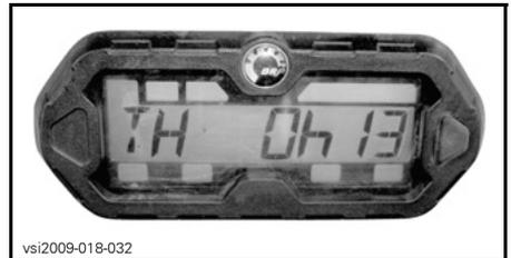
Pressione e **SEGURE** o botão seletor por 2 segundos para zerar o contador de horas de viagem.
