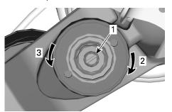
LOW SPEED COMPRESSION DAMPING (USE A SCREWDRIVER)
