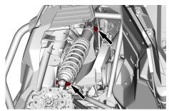
TYPICAL — FRONT SHOCK ABSORBER FASTENERS
