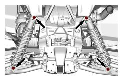
TYPICAL — REAR SHOCK ABSORBER FASTENERS
