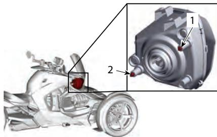
1. Tornillo de reglaje de la alineación horizontal (izquierda y derecha)
