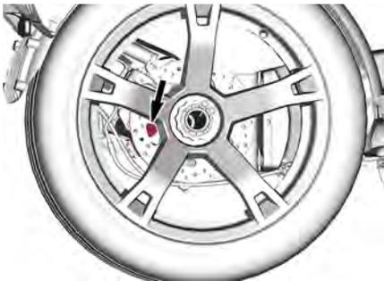
1. Gire la rueda trasera hasta que se pueda llegar al tapón de relleno a través de una apertura del freno de disco.
