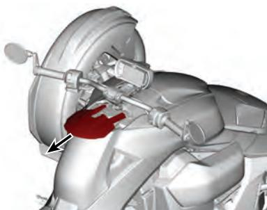
4. Si el vehículo está equipado con una tapa con cerradura para el depósito de combustible, libérela.
