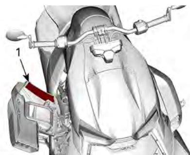
1. Etiqueta de presión de los neumáticos en el interior de la tapa de acceso lateral derecha
