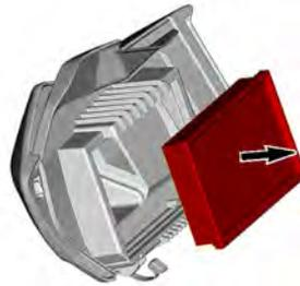
**Inspección del filtro de aire del motor**
