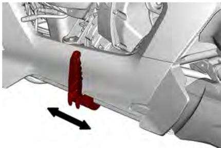
3. Baje el estribo en su posición para la conducción.
