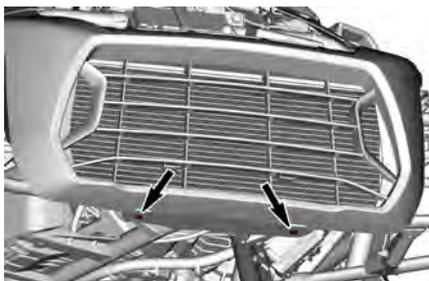
4. Enrolle hacia arriba las prolongaciones de la protección delantera para soltar las pestañas de sujeción traseras.
