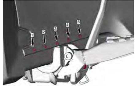
Después de ajustar los estribos y el pedal de freno, BRP recomienda que el conductor se siente en el vehículo en la posición de conducción para determinar si esta posición es la más adecuada y la más cómoda. El conductor también debe comprobar si el pedal se desliza completamente por su trayectoria de funcionamiento.
