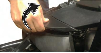
5. Tire de la protección frontal hacia adelante para desmontarla del vehículo.
