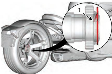
1. Extremo doblado apuntando hacia dentro del eje de la transmisión.
