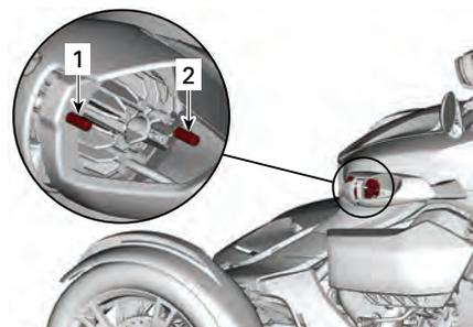
1. Tornillo de reglaje de la alineación horizontal (izquierda y derecha)
