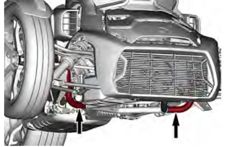
**UTILICE ESTOS TUBOS PARA LEVANTAR O APOYAR LA PARTE DELANTERA DEL VEHÍCULO**
