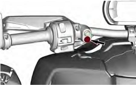
El control de velocidad de crucero permite conducir el vehículo a una velocidad constante. Aumentará o reducirá la velocidad del motor según se requiera.
