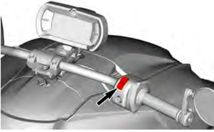
Para arrancar el motor, cambie el interruptor de parada del motor a la posición de marcha (RUN).
