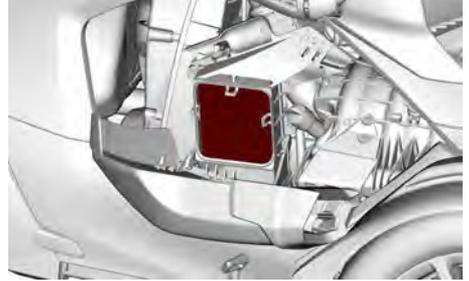
1. Desmonte el tornillo que sujeta la parte inferior de la carcasa del filtro de aire de la CVT.
