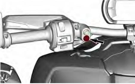
Il pulsante cruise control permette di mantenere una velocità costante durante la guida. Questo aumenterà o diminuirà i giri del motore in base alla necessità.
