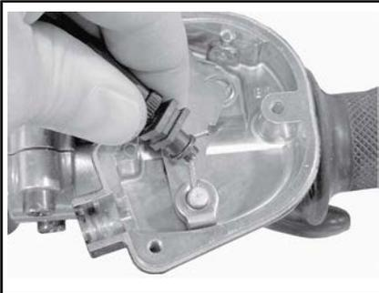
Entfernen Sie die Seitenabdeckung der Drosselklappe.
