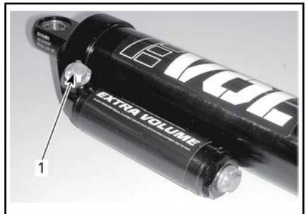
1. *Deckel des HAUPT-Luftkammerventils*
