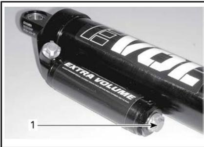
1. *Deckel des EVOL Luftkammerventils*
