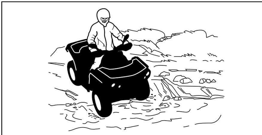
Nasse Bremsen beeinträchtigen die Bremsleistung Ihres Fahrzeugs. Sorgen Sie durch mehrfaches Betätigen dafür, dass Ihre Bremsen wieder trocken werden, nachdem das Fahrzeug das Wasser, Schlamm oder Schnee verlassen hat.
