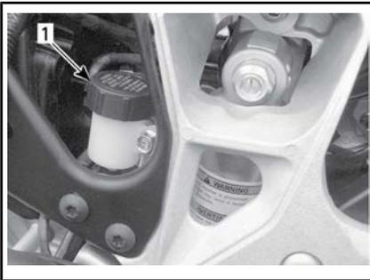
*BEFINDET SICH IN DER NÄHE DES RECHTEN HINTEREN KOTFLÜGELS*
