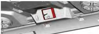
2. 如下图所示，卸下并保留固定主机的四个 M4 x 12 螺钉。
