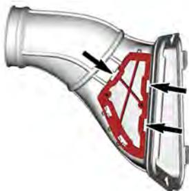
6. 拆卸 CVT 空气滤清器。
