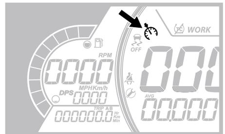
L'activation du mode Limiteur de vitesse définit uniquement la vitesse maximale accessible en appuyant sur l'accélérateur.
