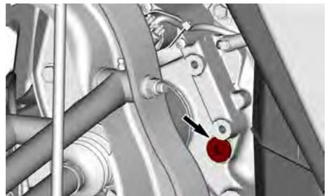
4. Retirez le bouchon de remplissage.
