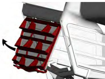
Lavez le filtre à air avec de l'eau tiède et du savon doux. Éliminez l'excès d'eau et laissez sécher à l'air avant de les réinstaller.
