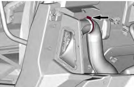
4. Retirez le boîtier du filtre du véhicule.
