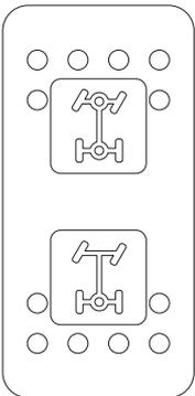
Le commutateur sélectionne le mode 2 roues motrices ou le mode 4 roues
