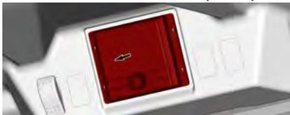
4. Retirez ensuite délicatement le faisceau, en veillant à ne pas endommager les fils ou les connexions. Localisez le couvercle du fusible.
