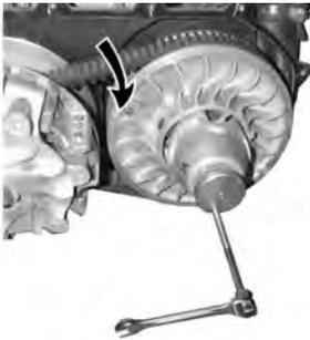
**Installation de la courroie d'entraînement**
