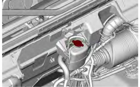
4. Vérifiez que le système de refroidissement est rempli jusqu'à la ligne de capacité maximale.
