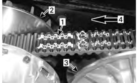
1. Flèche imprimée sur la courroie
