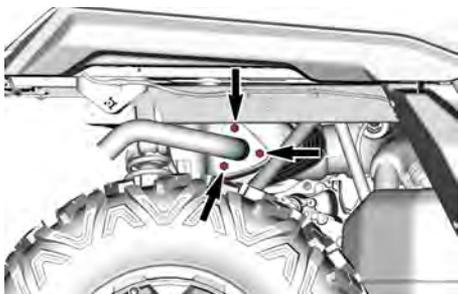
2. Rimuovere il tubo di coda di scarico, la guarnizione (eliminare) e il parascintille.
