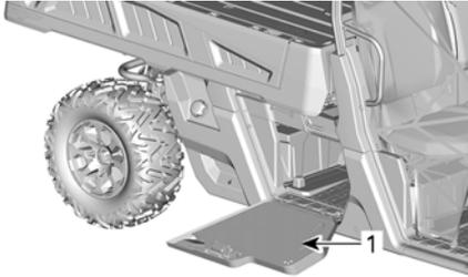
Rimuovere il coperchio della batteria svitando i due dispositivi di fissaggio di 1/4 di giro.
