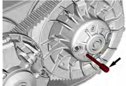
4. Ruotare la puleggia condotta fino a quando la parte più bassa degli ingranaggi che si trovano sulla superficie esterna della cinghia di trasmissione è a livello con il bordo della puleggia condotta.
