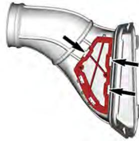
6. Rimozione del filtro dell'aria CVT.
