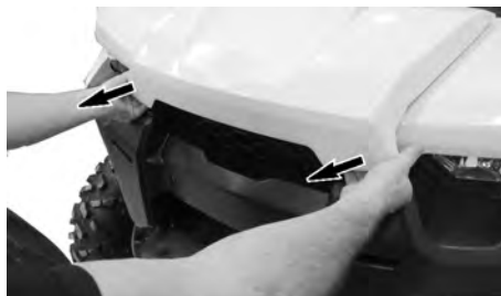
TIRARE DAL BORDO COPERCHIO DI MANUTENZIONE ANTERIORE.
