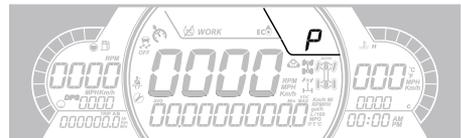
Diese Anzeige zeigt die Getriebestellung an:
