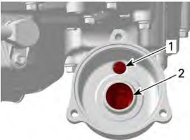
1. Einlass-Bohrung der Ölpumpe zum Ölfilter
