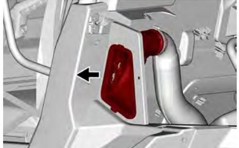
5. Drücken Sie die Filterlaschen, um den Filter zu lösen.
