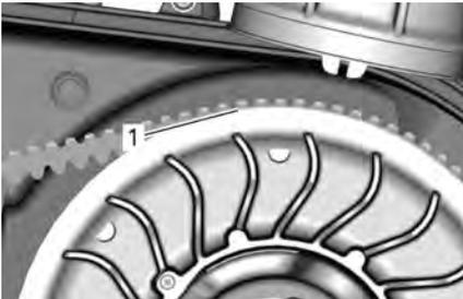
1. Unterster Teil der Zahnräder bündig mit der Abtriebsscheibenkante
