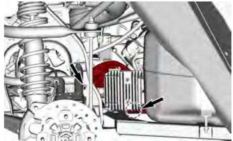
**MONTAGESTELLE DER BEFESTIGUNGSTEILE FÜR DEN SPANNUNGSREGLERHALTER**
