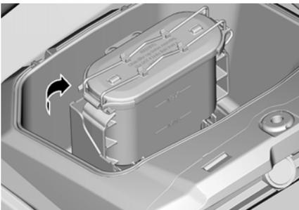
Füllen Sie Bremsflüssigkeit nach Bedarf auf. **Nicht überfüllen.**
