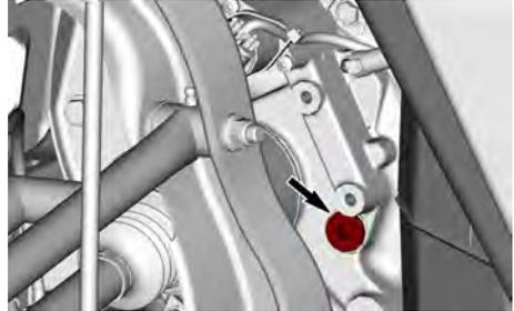
4. Entfernen Sie den Einfüllstopfen.
