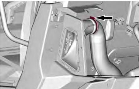
4. Entfernen Sie das Luftfiltergehäuse vom Fahrzeug.
