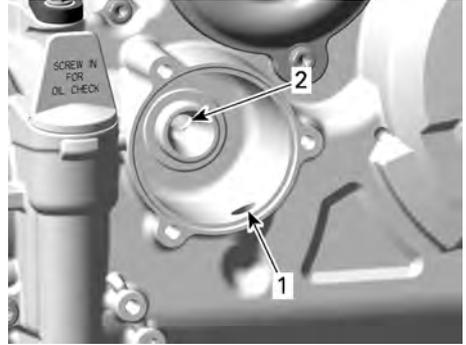
1. Einlass-Bohrung der Ölpumpe zum Ölfilter
