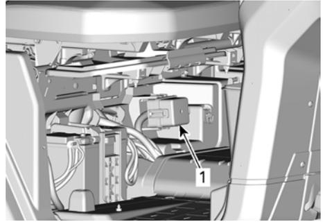
1. Hinterer zweiter Sicherungskasten
