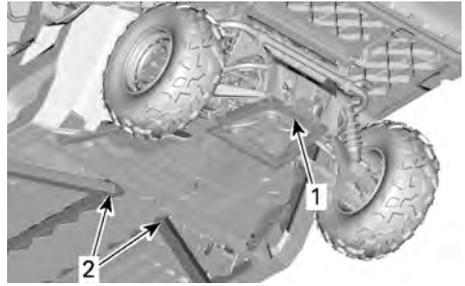
1. Hebestelle unter der Schutzplatte
