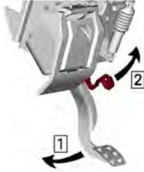
Schritt 1. Betätigen Sie das Bremspedal und halten Sie es gedrückt.
