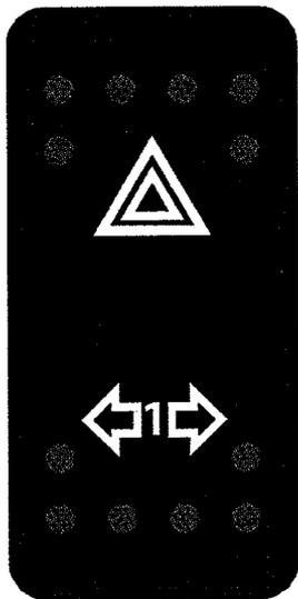
Este interruptor activa todos los intermitentes simultáneamente. Se utiliza cuando el vehículo está parado, para indicar que el vehículo obstruye el tráfico temporalmente.
