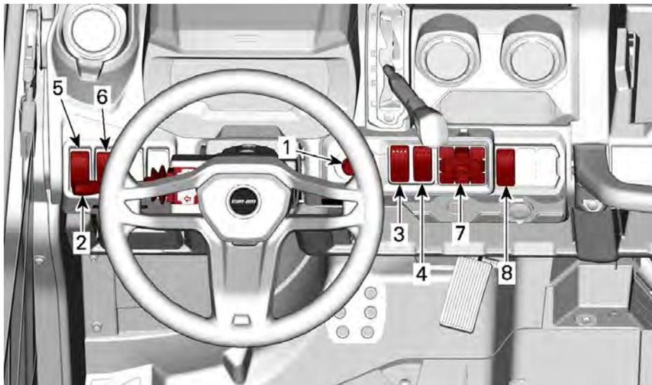
1. Interruptor de encendido o conector D.E.S.S., y botón de arranque.
