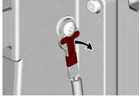
3. Levante la compuerta trasera a 45°.
