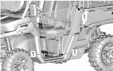
1. Locaties waar het zijnet wordt aangespannen
