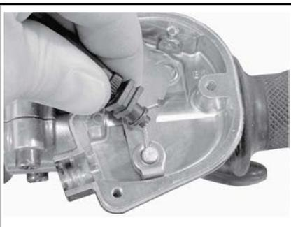
Remova a proteção lateral do corpo de acelerador.
