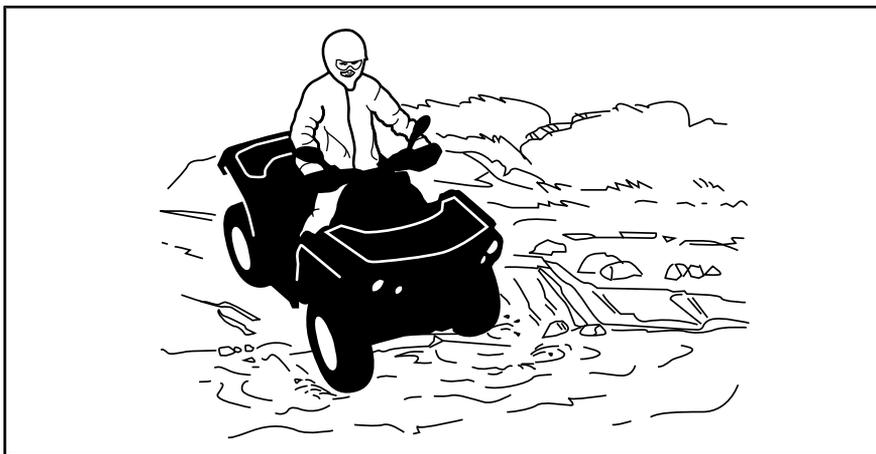
Freios molhados afetam a capacidade de frenagem do seu veículo. Certifique-se de secar os freios, aplicando-os várias vezes depois de sair da água, lama ou neve.
