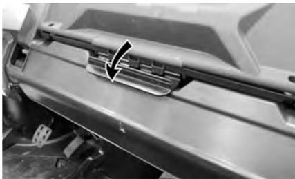
2. Zum Schließen des Deckels senken Sie ihn ab und schieben Sie die Verriegelung nach oben.
