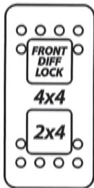
Mit diesem Schalter wird bei stehendem Fahrzeug der Zweirad- oder Vierradantriebsmodus ausgewählt.
