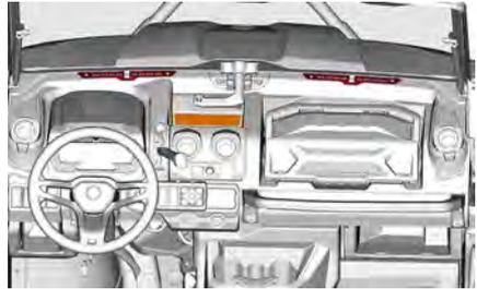
Der Luftstrom kann mit dem mittleren Knopf geregelt werden.
