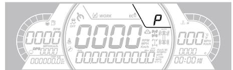
Diese Anzeige zeigt die Getriebestellung an:
