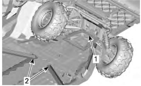
1. Hebestelle unter der Schutzplatte
