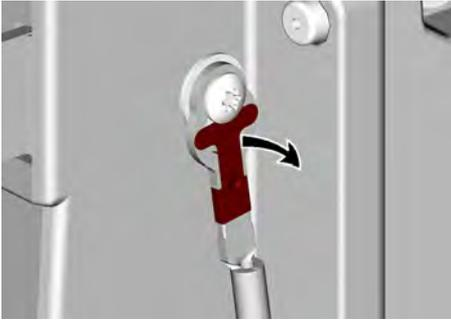
3. Heben Sie die Ladeklappe um 45° an.
