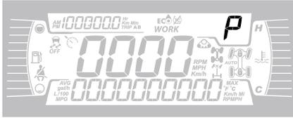
Diese Anzeige zeigt die Getriebestellung an:
