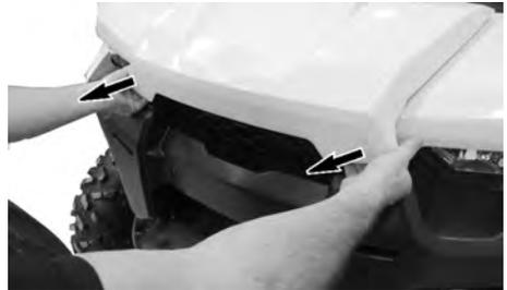
AN DEN VORDEREN KANTEN DER WARTUNGSABDECKUNG ZIEHEN.
