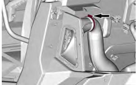
4. Entfernen Sie das Luftfiltergehäuse vom Fahrzeug.
