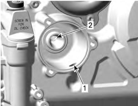
1. Einlass-Bohrung der Ölpumpe zum Ölfilter
