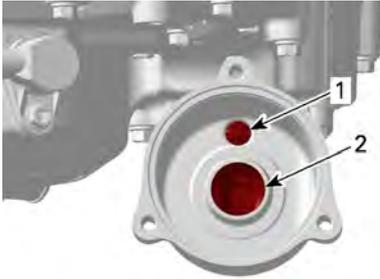
1. Einlass-Bohrung der Ölpumpe zum Ölfilter
