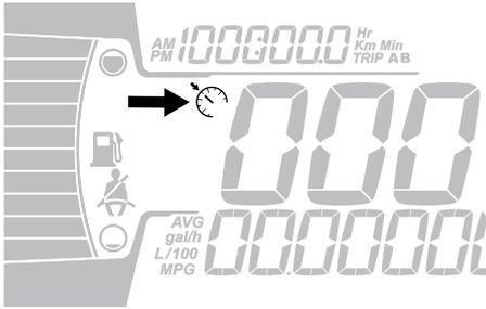
Bei Aktivierung des Geschwindigkeitsbegrenzungsmodus wird nur die verfügbare Höchstgeschwindigkeit bei Betätigung des Gaspedals beschränkt.
