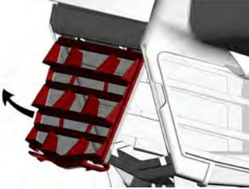
Reinigen Sie den Luftfilter, indem Sie ihn in einer Mischung aus lauwarmem Wasser und milder Seife waschen. Entfernen Sie überschüssiges Wasser und trocknen Sie die Filter vor dem Einbau an der Luft.
