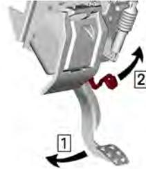
*Schritt 1. Betätigen Sie das Bremspedal und halten Sie es gedrückt.*
