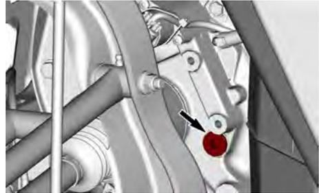
4. Entfernen Sie den Einfüllstopfen.
