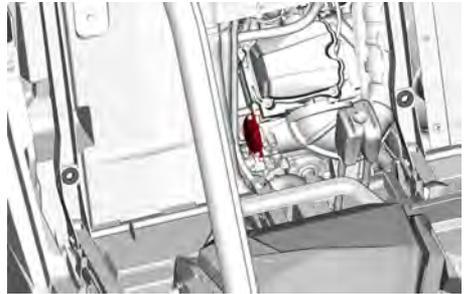
3. Entfernen Sie die Ölfilterabdeckung.
