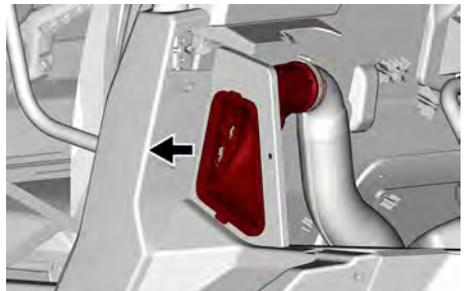
5. Drücken Sie die Filterlaschen, um den Filter zu lösen.
