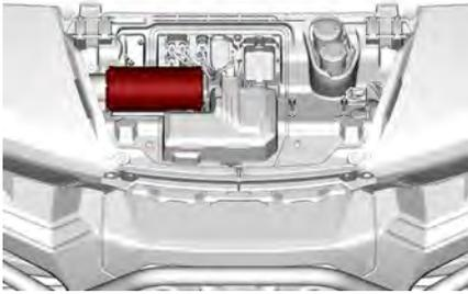
Zum Ausbauen Filter anheben und verschieben.
