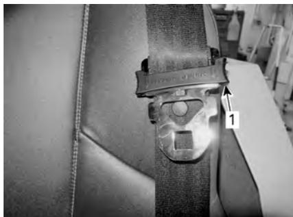
**TÍPICO****1. Pestaña de bloqueo de deslizamiento**
