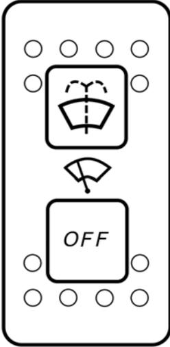
Este conmutador se utiliza para seleccionar las posiciones de APAGADO, limpiaparabrisas o lavaparabrisas/ limpiaparabrisas.
