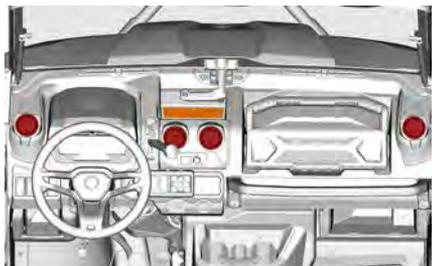
Presione el punto moldeado para abrir la ventilación.
