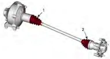
1. Fuelle del eje de transmisión - lado del diferencial
