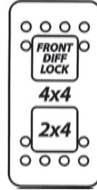
Este interruptor permite seleccionar el modo de tracción a 2 o a 4 ruedas con el vehículo parado.
