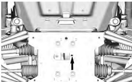
4. Coloque una bandeja de drenaje debajo del diferencial trasero.
