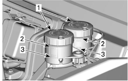
1. Depósitos de líquido de frenos
