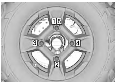
SEQUENZA DI SERRAGGIO
