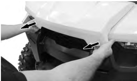
TREKKEN AAN DE RAND VAN HET VOORSTE ONDERHOUDSDEKSEL.
