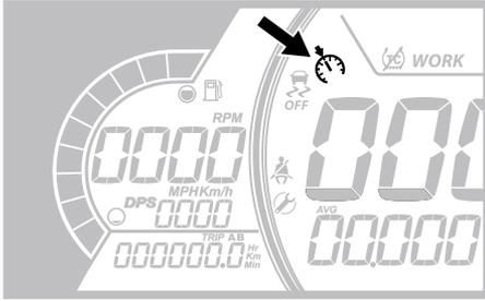
Ativar o modo de operador do limitador de velocidade do utilitário somente limita a velocidade máxima disponível ao pressionar o acelerador.
