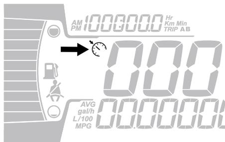
Ativar o modo de operador do limitador de velocidade do utilitário somente limita a velocidade máxima disponível ao pressionar o acelerador.
