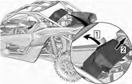
Entfernen Sie das CVT-Luftfilter vom Fahrzeug.
