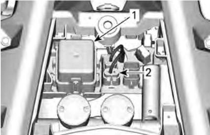
1. Vorderer Sicherungskasten
