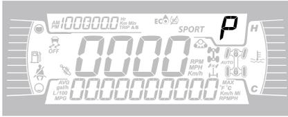
Diese Anzeige zeigt die Getriebestellung an:
