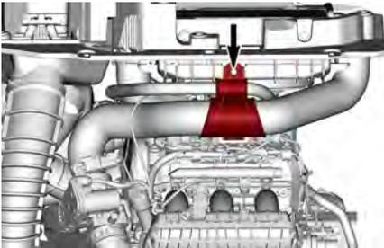
Heben Sie die Zwischenkühlerbau-
