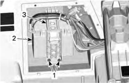
1. Halteschrauben des Batteriebügels
