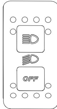
Dieser Schalter wird zum Wechseln zwischen Fern- und Abblendlicht verwendet.
