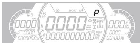
Diese Anzeige zeigt die Getriebestellung an:
