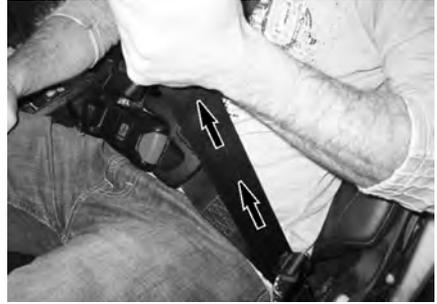
Um den Sitzgurt zu lösen, halten Sie mit einer Hand den Beckengurt und ziehen den roten Riemen nach aussen.
