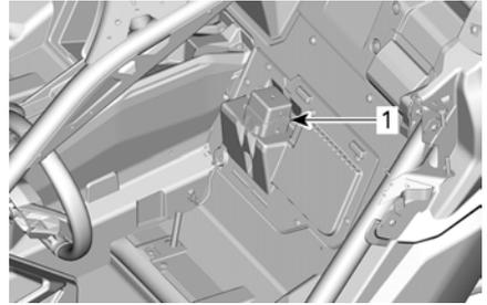
1. Hinterer Sicherungskasten
