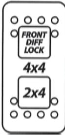
Mit diesem Schalter wird bei stehendem Fahrzeug und laufendem Motor der Zweirad- oder Vierradantriebsmodus ausgewählt.
