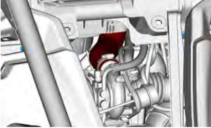
Den Ladeluftkühler und die Schlauchhalterung des Kurbelgehäuses durch Lösen der Schraube öffnen.
