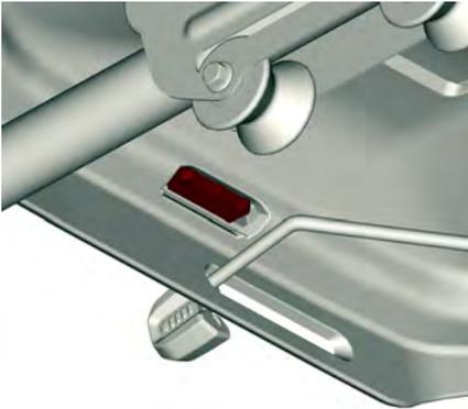
Ziehen Sie das hintere Ende des Kissens hoch und dann aus dem Rahmen, indem Sie es nach hinten herausziehen.
