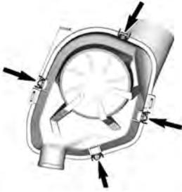
Entfernen Sie die Filterpatrone.
