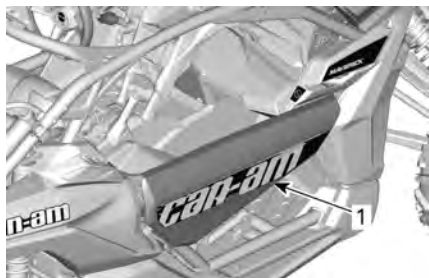
1. Puerta cerrada y correctamente bloqueada.
