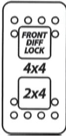
Questo selettore seleziona 2 ruote motrici o 4 ruote motrici quando il veicolo è fermo e il motore è acceso.
