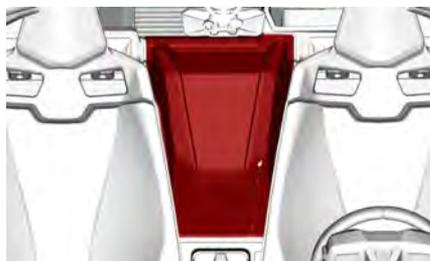
Rimuovere le viti di fissaggio anteriori della piastra di protezione.
