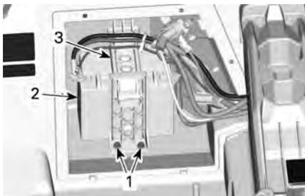
1. Parafusos de retenção do suporte da bateria
