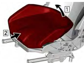
Para instalação, inverta o procedimento de remoção.
