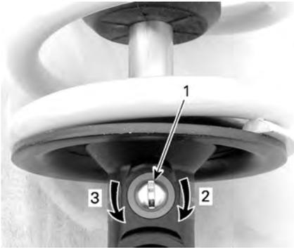
1. Dispositif de réglage de l'amortissement des rebonds
