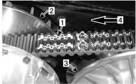
1. Flèche imprimée sur la courroie
