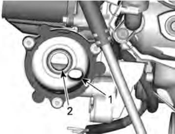
1. Orifice de sortie allant au système d'approvisionnement en huile du moteur
