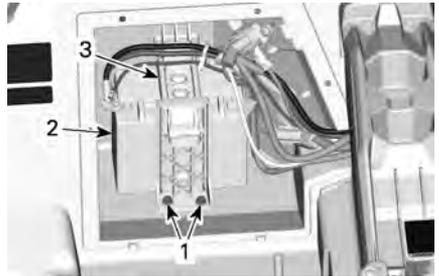
1. Vis de fixation du support de la batterie
