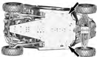
POSIZIONI DEL MARTINETTO - LATO ANTERIORE DEL VEICOLO
