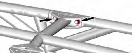
DISPOSITIVI DI FISSAGGIO CENTRALI SUPERIORI
