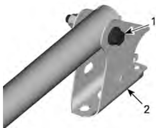
POINT DE FIXATION AVANT EN POSITION ÉLEVÉE
