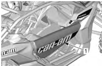
1. Porta fechada e corretamente travada
