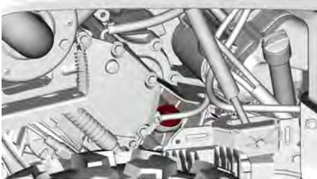
3. Coloque una bandeja de drenaje debajo del área del tapón de drenaje de aceite.
