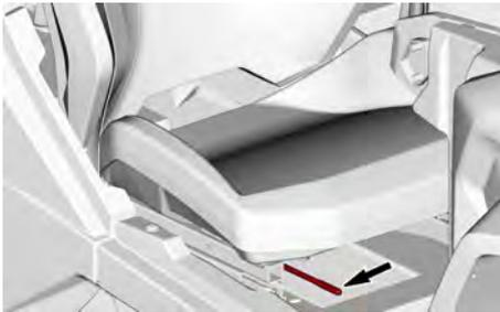
Suelte la palanca para bloquear el asiento en posición.
