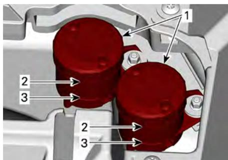
1. Depósitos de líquido de frenos
