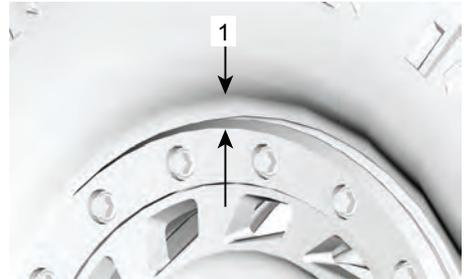
1. Hueco uniforme alrededor del anillo de la abrazadera del sistema de bloqueo de talón
