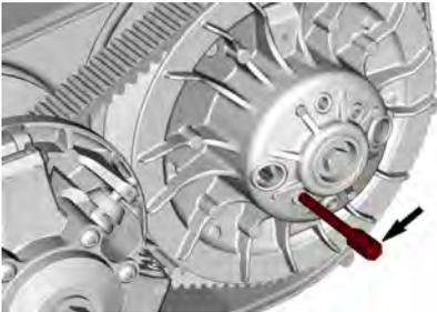
4. Gire la polea pasiva hasta que la porción más baja de los piñones de la superficie exterior de la correa de transmisión esté alineada con el borde de la polea pasiva.
