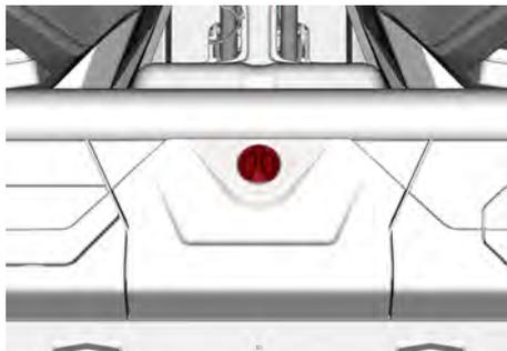
2. Instale la tapa de servicio de la parte trasera en su sitio y gire el tornillo de cuarto de vuelta en sentido horario.
