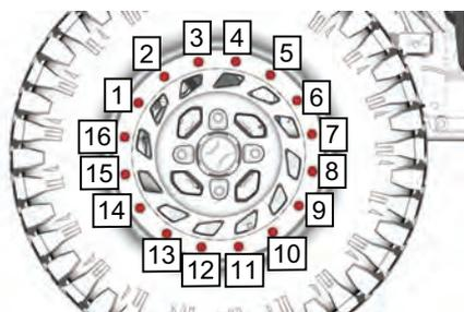
9. Hinche el neumático para asentar el talón interior en la llanta. Utilice siempre prácticas seguras, por ejemplo, haga uso de una jaula de seguridad para neumáticos.
