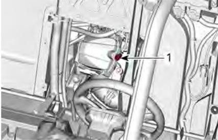
1. Bujía delantera del motor bicilíndrico en V
