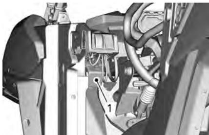
1. Vorderer Sicherungskasten
