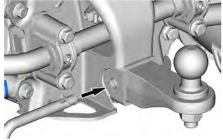
Sichern Sie den Stift durch Einklappen der Verriegelung.
