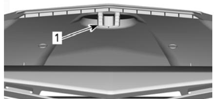
1. Schlitz an der Unterseite der Wartungsabdeckung finden
