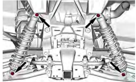
*TYPISCH - BEFESTIGUNGSTEILE FÜR HINTERE STOßDÄMPFER*
