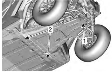
1. Hebestelle unter der Schutzplatte
