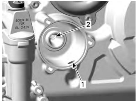
1. Einlass-Bohrung der Ölpumpe zum Ölfilter
