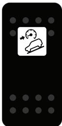
Um den HDC-Schalter zu aktivieren/deaktivieren drücken Sie diesen und halten ihn mindestens 0,5 Sekunden gedrückt, (HDC ON/OFF wird im unteren Bereich der Anzeige angezeigt, und das Symbol für die Traktionskontrolle
