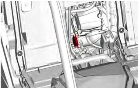
3. Entfernen Sie die Ölfilterabdeckung.
