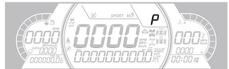
Diese Anzeige zeigt die Getriebestellung an:
