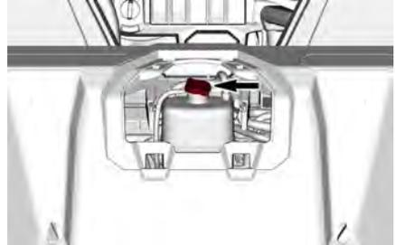
2. Geben Sie nach Bedarf Kühlmittel in das System. Mit einem Trichter vermeiden Sie das Verschütten von Flüssigkeit. **Nicht überfüllen.**
