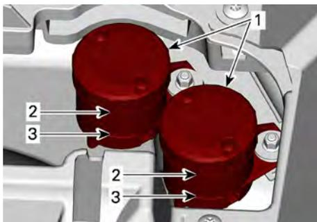
1. Depósitos de líquido de frenos
