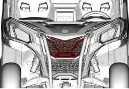
2. Revise el radiador y las mangueras para descartar la presencia de fugas y daños.
