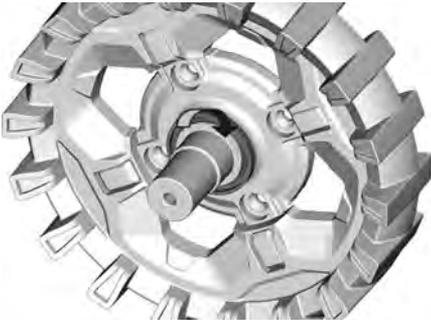
3. Schmieren Sie die Nabe nach dem Austausch der Nabe und/oder dem Neueinbau der Nabe und füllen Sie 25 ml (0.85 fl oz (US)) Öl in die Öffnung an der Oberseite des Nabengehäuses.
