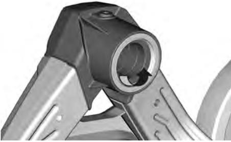
2. Nabenverschleißbuchse schmieren. Tragen Sie 2 ml (0.07 fl oz (US)) Fett gleichmäßig auf die gesamte Breite und den Umfang (360°) der Nabenverschleißbuchse auf.
