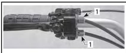
1. Parafusos de ajuste na alavanca
