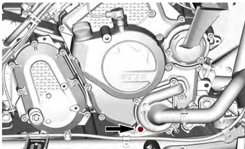
3. Zum Schluss lösen Sie den unteren Kühlerschlauch von der Abdeckung der Wasserpumpe und lassen Sie das übrige Kühlmittel in einen geeigneten Behälter ablaufen.
