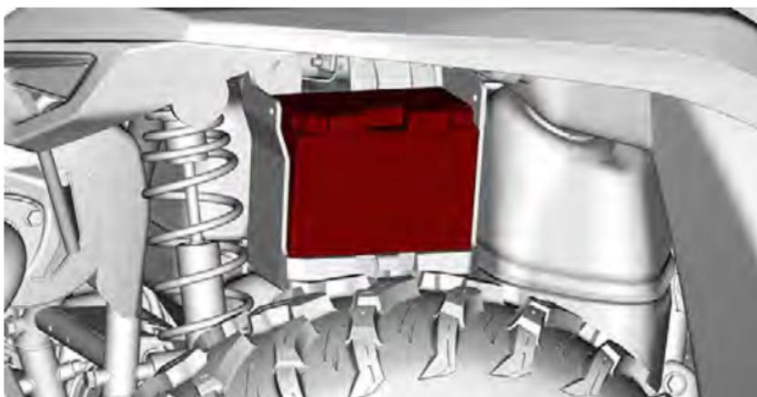
2. Die Batterie mit dem Halteriemens sichern.
