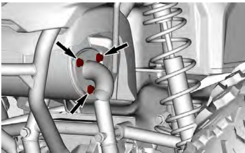
2. Bauen Sie das Auspuffendrohr mit Funkenschutz und die Dichtung aus (alles entsorgen).
