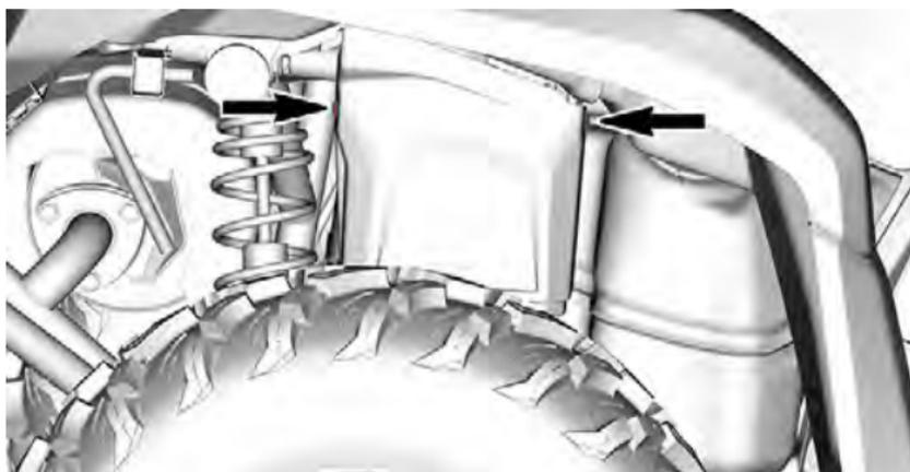
2. Entfernen Sie die Batterieabdeckung.
