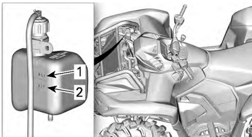
Um Kühlmittel nachzufüllen, schrauben Sie die Kühlmitteldruckkappe ab.
