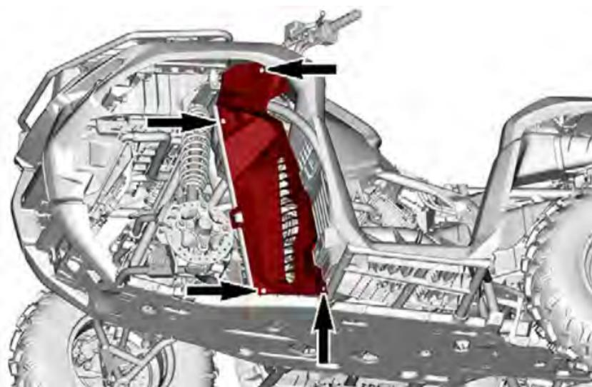
3. Entfernen Sie die linke vordere Fußstütze.
