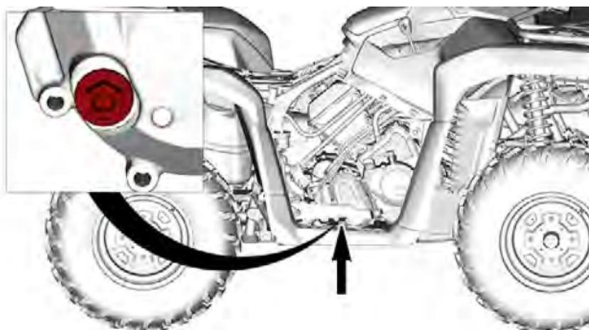
5. Ölfüllstand überprüfen. Das Öl muss bis zur Unterkante der Ölfüllstandsöffnung reichen.
