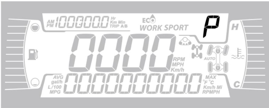
Diese Anzeige zeigt die Getriebestellung an:
