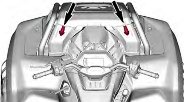
2. Öffnen Sie die Abdeckung, indem Sie sie zur Fahrzeugfront hin neigen.
