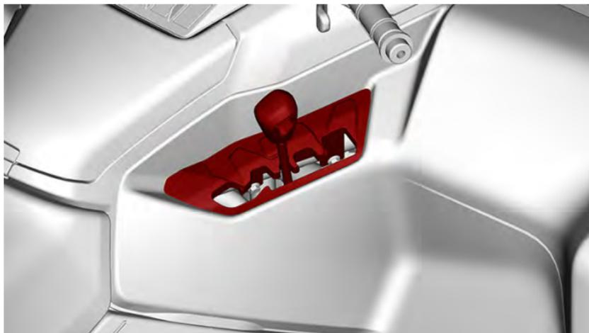
Mit dem Schalthebel wird die Getriebestellung verändert.
