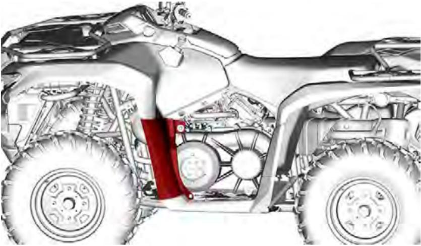
4. Ziehen Sie den Kühllufteinlassschlauch von der CVT-Abdeckung ab.
