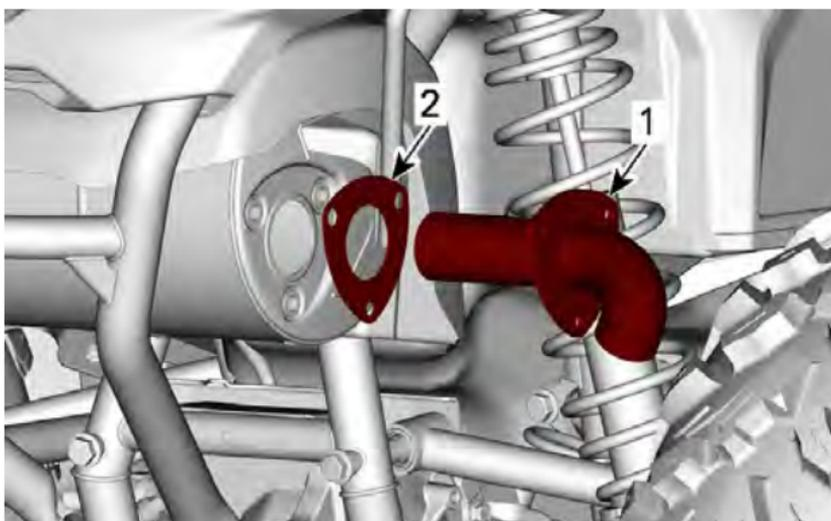
1. Abgasendrohr mit Funkenschutz
