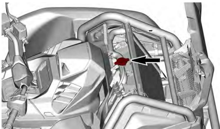
3. Befüllen Sie den Kühlmittelbehälter bis zur Markierung MAX.
