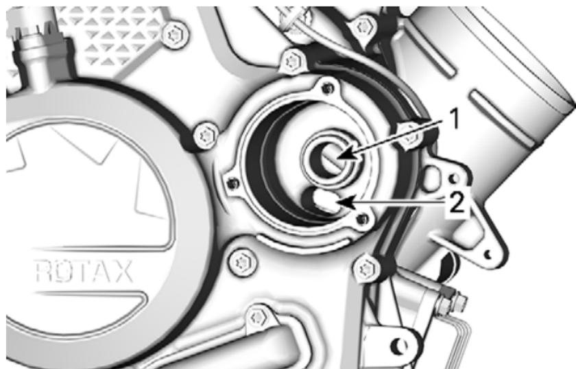
1. Auslass-Bohrung zur Ölspeisung des Motors
