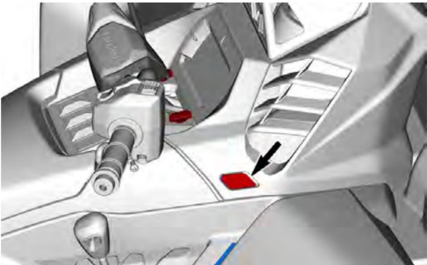
3. Lösen Sie beide Verriegelungslaschen an den Seiten der Lenkung.
