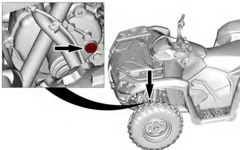
3. Entfernen Sie den Einfüllstopfen.
