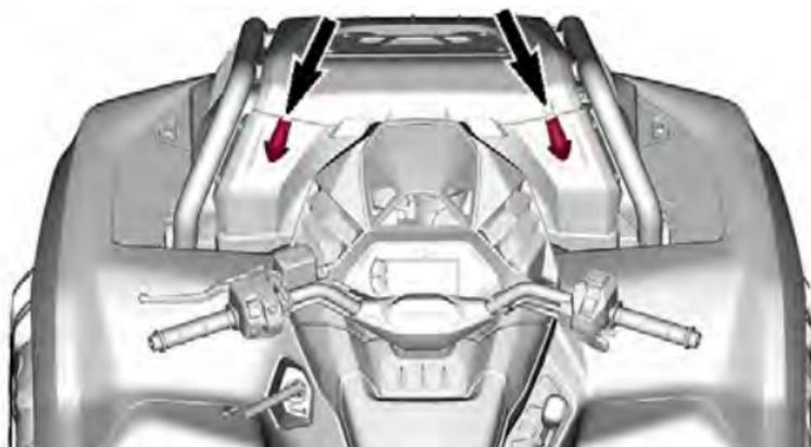
2. Ouvrez le couvercle en le faisant basculer vers l'avant du véhicule.
