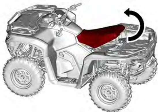
3. Continuez de soulever le siège jusqu'à ce que vous puissiez dégager le mécanisme de retenue avant, puis retirez le siège complètement.
